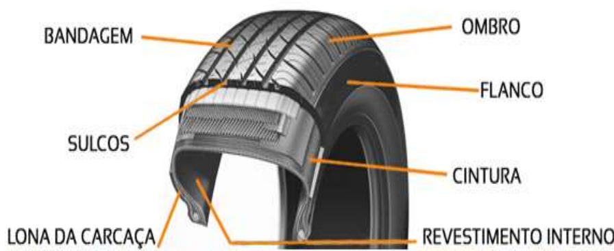
Figura 3: Composição do pneu
