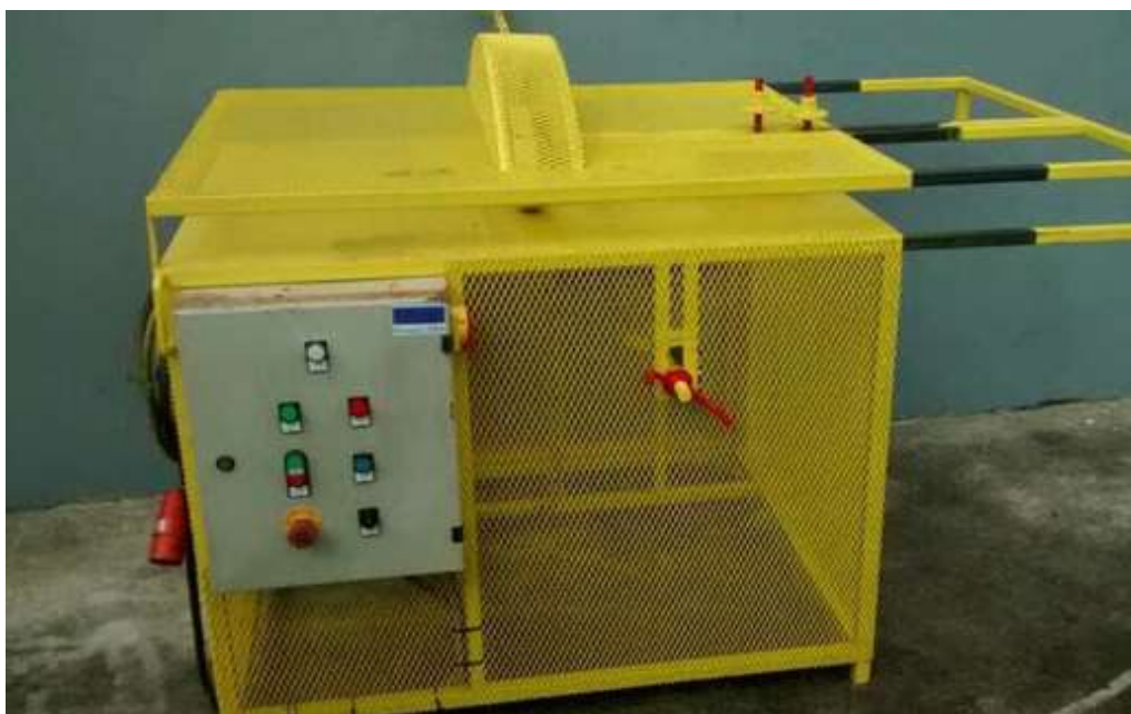
Figura 3: Serra circular de bancada após readequação
