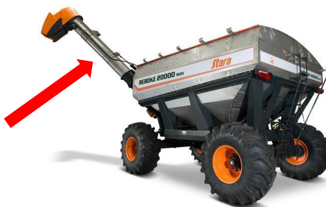
Figura 2: Helicóide tubo de descarga articulado REBOKE 20000.
