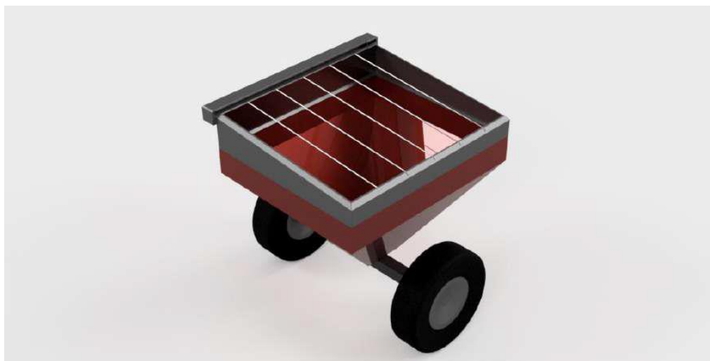
Figura 30: Montagem do sistema na carreta graneleira.
