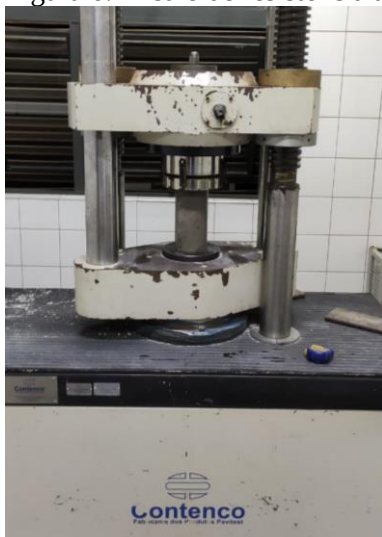
Figura 6: Ensaio de resistência à compressão.
