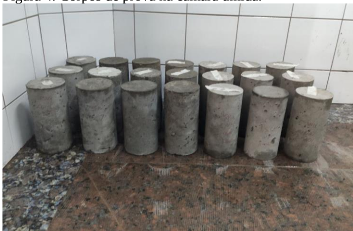
Figura 4: Corpos de prova na câmara úmida.
