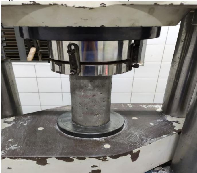
Figura 7: Ensaio de resistência à compressão.
