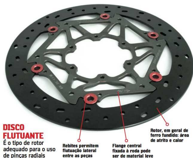
Figura 8- Disco de freio flutuante
