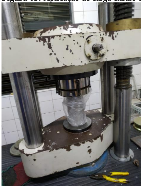
Figura 05: Aplicação de carga ensaio de compressão axial
