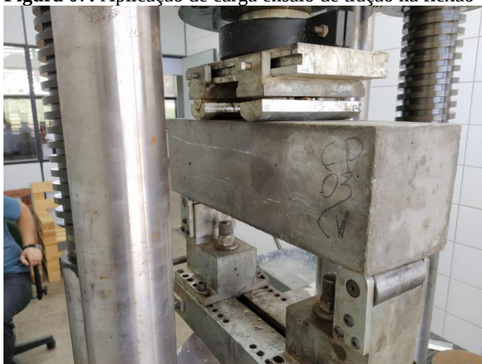
Figura 07: Aplicação de carga ensaio de tração na flexão
