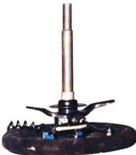
Figura 1: Volante com a coluna de direção quebrada.
