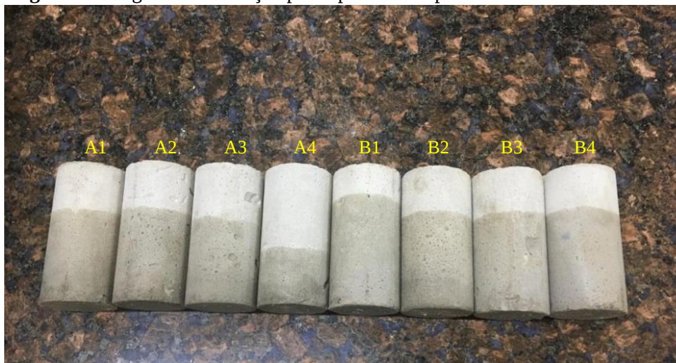
Figura 15: Registro de absorção por capilaridade após uma hora do início do ensaio
