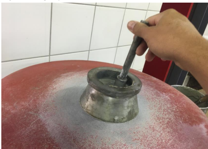
Figura 4: Preparação do ensaio de índice de consistência.
