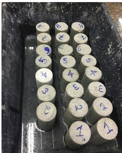
Figura 8: Imersão dos corpos de prova no recipiente.
