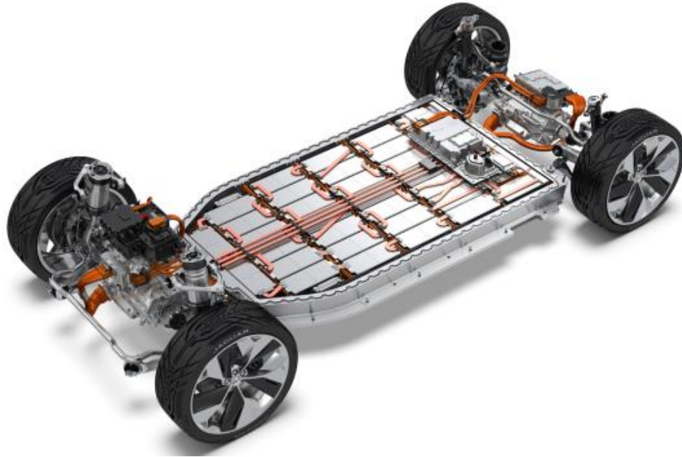
Figura 5: Chassi elétrico jaguar i-pace.
