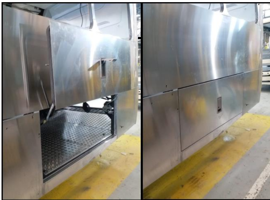
Figura 4: Componente portinhola montada na carroceria
