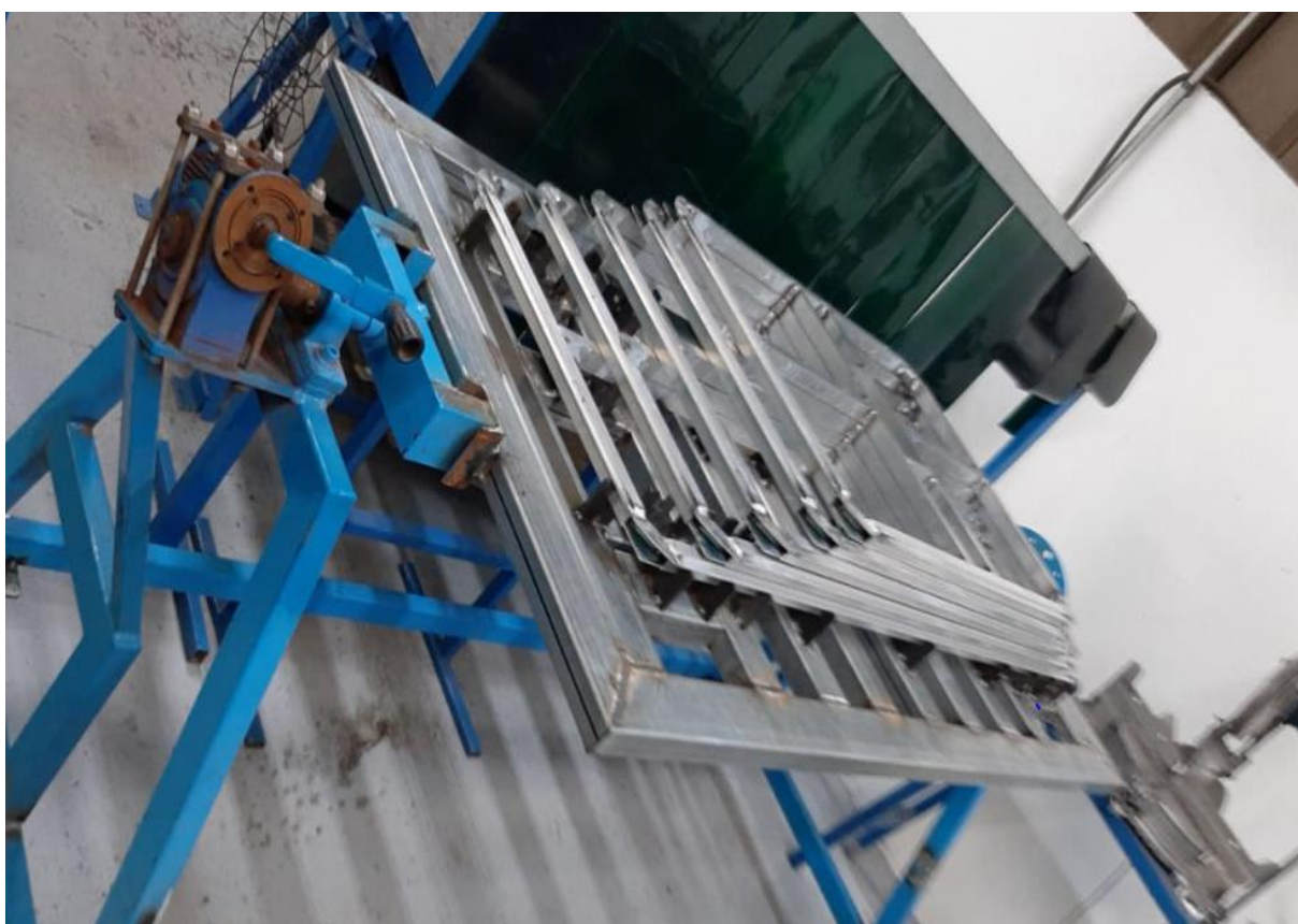
Figura 14: Gabarito e estruturas de portinholas
