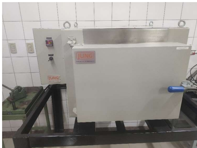
Figura 5: Forno de alta temperatura com controlador digital (Fonte: Autor)
