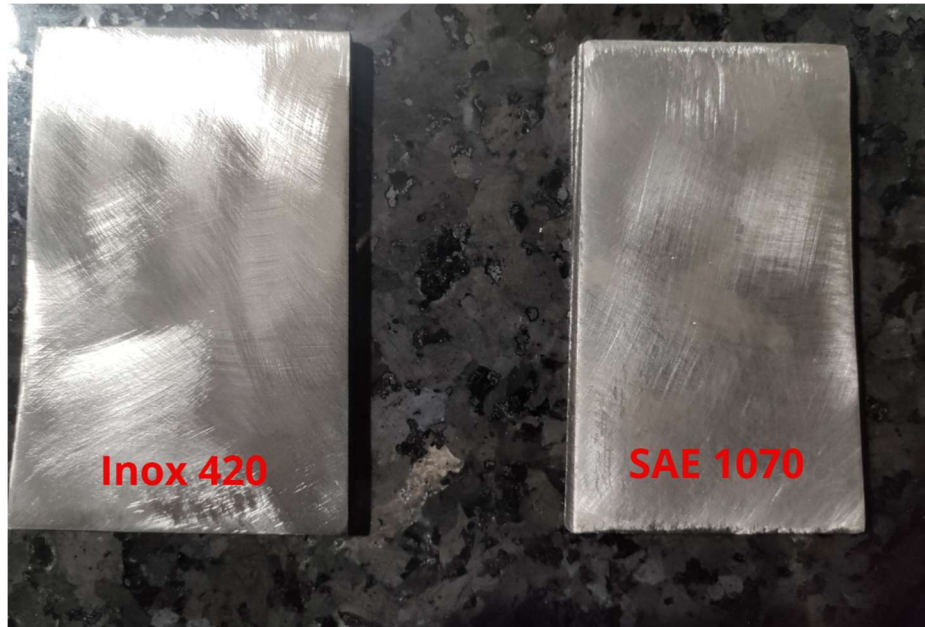
Figura 4: Apresenta as amostras dos aços depois de cortadas antecedendo o tratamento térmico
