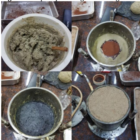
Figura 12: Aplicação da argila e montagem do Permeâmetro
