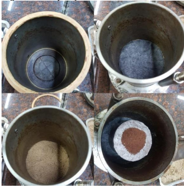
Figura 11: Preparação da base do Permeâmetro
