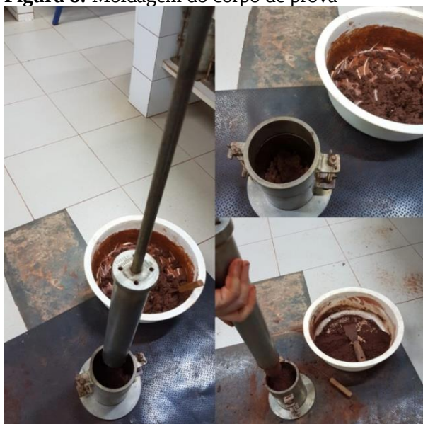
Figura 8: Moldagem do corpo de prova
