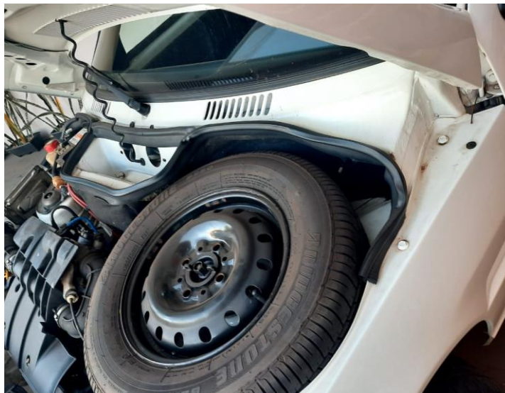
Figura 23 - Painel corta-fogo com vista externa no automóvel de modelo uno
