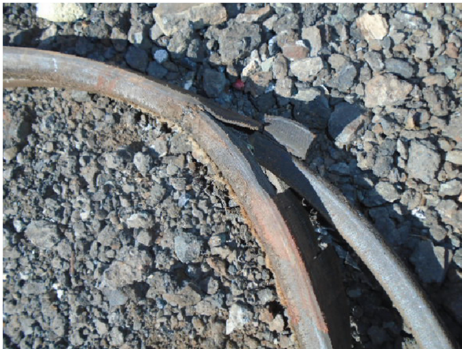
Figura 7: Fotografia retirada pelo regulador dos detalhes dos danos nas correias (Fonte: Acervo dos autores, 2020)
