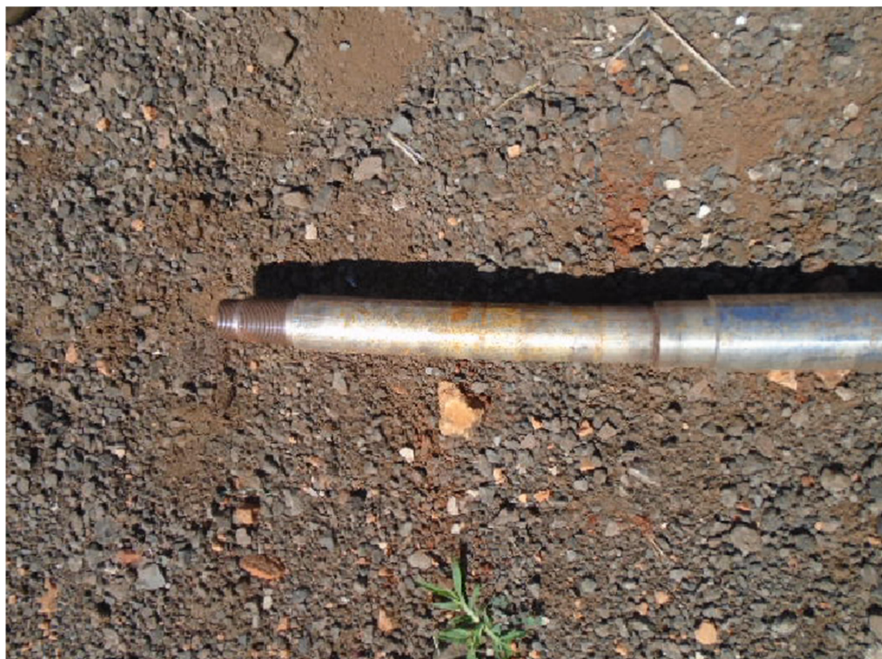
Figura 6: Fotografia retirada pelo regulador do eixo danificado, o qual apresenta empenamento na extremidade (Fonte: Acervo dos autores, 2020)
