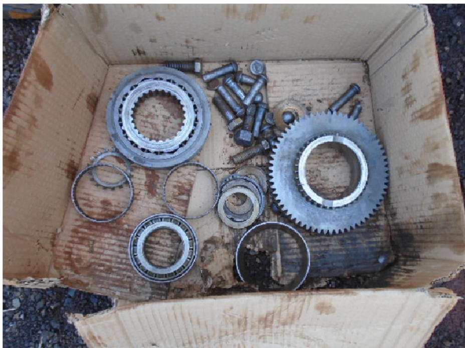
Figura 8: Fotografia retirada pelo regulador dos demais componentes internos danificados (Fonte: Acervo dos autores, 2020)
