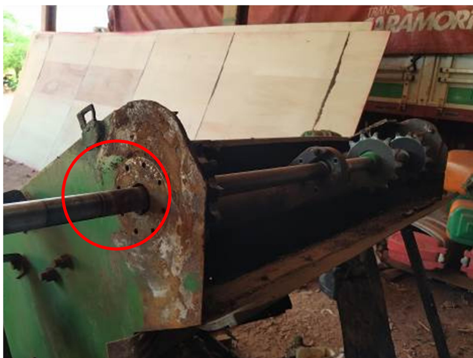
Figura 2: Fotografia retirada pelo regulador do sistema e alimentação da colheitadeira, em que é possível evidenciar o eixo responsável pelo movimento da corrente de elevação (Fonte: Acervo dos autores, 2020)
