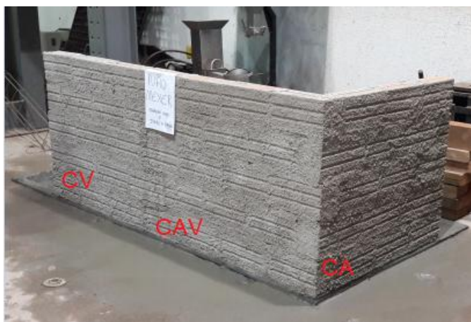
Figura 2: Execução do chapisco na alvenaria.
