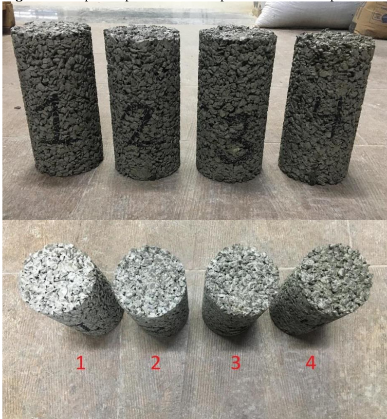
Figura 2: Corpos de prova moldados para ensaio de compressão numerados de 1 a 4.
