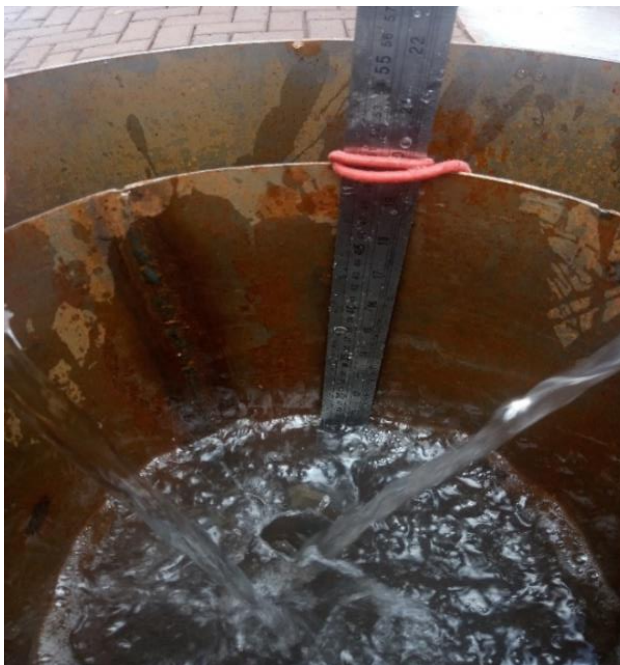
Figura 12: Processo de enchimento no cilindro interno.
