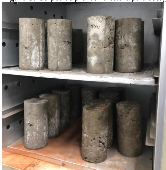
Figura 5: Corpos de provas na estufa para secagem.
