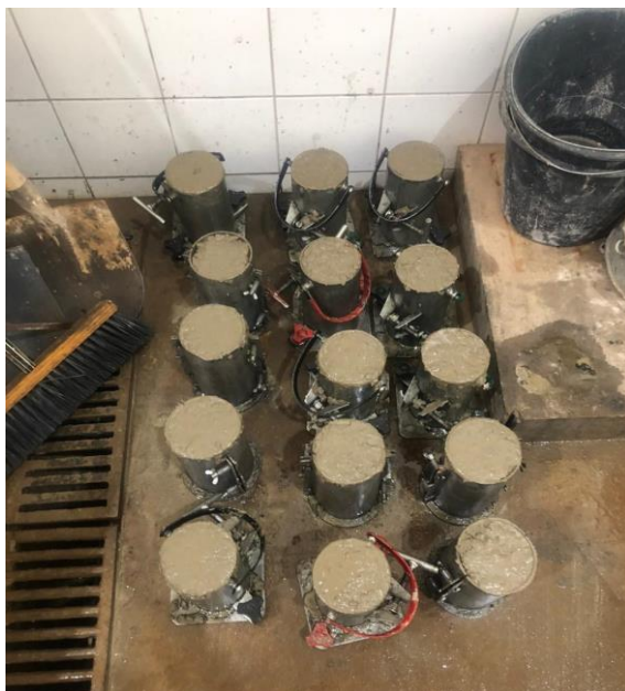
Figura 2: Moldagem dos corpos de prova.
