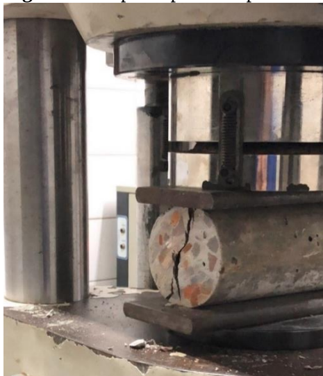
Figura 4: Corpo de prova na prensa hidráulica para ensaio tração por compressão diametral.
