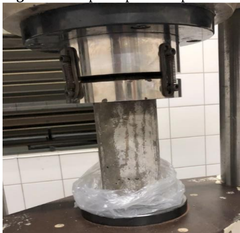
Figura 3: Corpo de prova na prensa hidráulica para ensaio de compressão axial.
