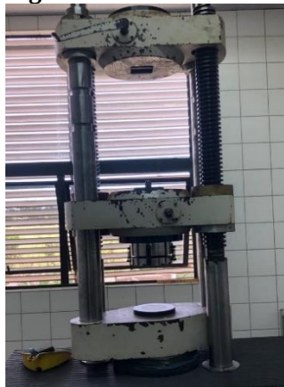
Figura 8: Prensa utilizada para o ensaio de compressão axial.
