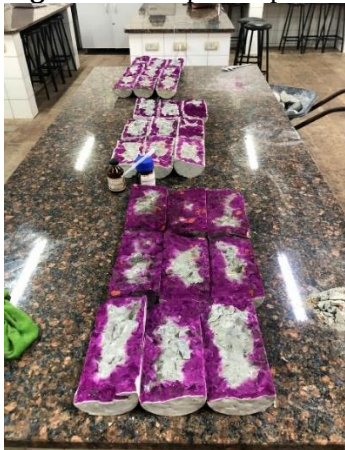
Figura 10: Corpos de prova que foram aplicados a solução de fenolftaleína.
