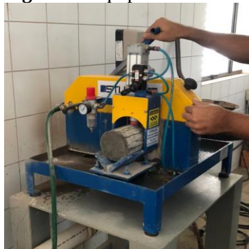
Figura 7: Equipamento utilizado para planificar o topo dos corpos de prova.
