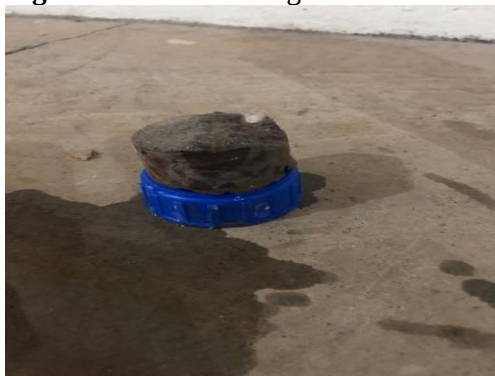
Figura 9 – Amostra reagindo com a fenolftaleína
