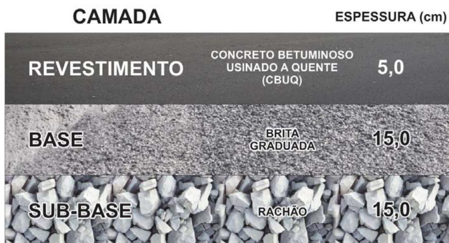
Figura 14 – Estrutura do pavimento asfáltico
