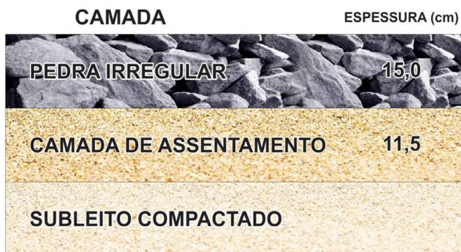
Figura 15 - Estrutura do pavimento poliédrico
