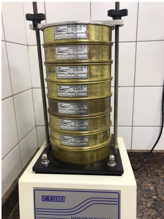
Figura 5: Sequência de peneiramento e agitador mecânico
