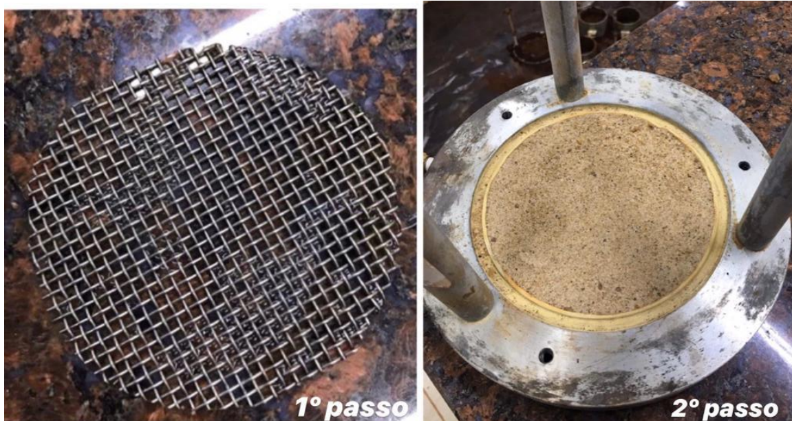
Figura 8: Etapas iniciais de montagem da base do permeâmetro
