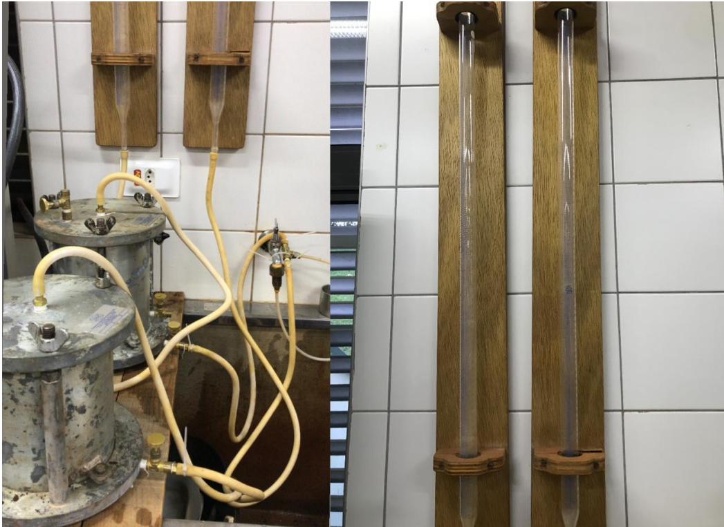
Figura 7: Permeâmetro de carga variável e bureta graduada
