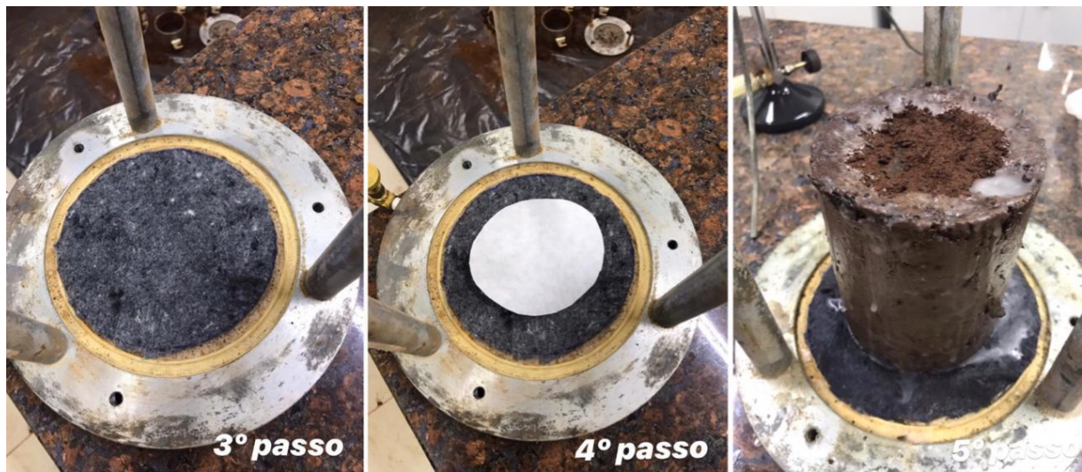
Figura 9: Etapas finais para montagem da base do permeâmetro
