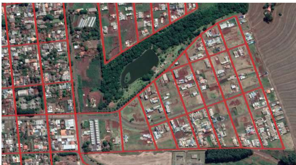
Figura 12 - Rede de esgoto
