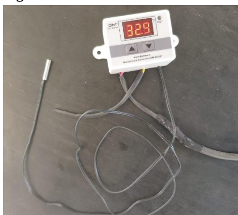
Figura 8: Termostato utilizado nas medições.
