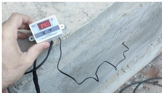
Figura 9: Leitura utilizando o termostato digital.
