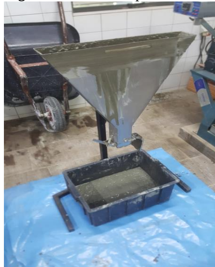
Figura 21: Concreto após a abertura da comporta
