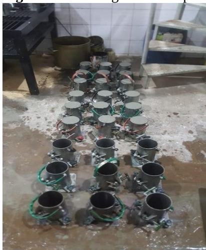
Figura 26: Moldagem dos corpos de prova
