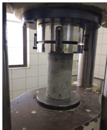
Figura 27: Ensaio de resistência à compressão
