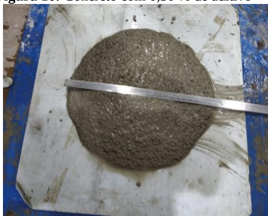
Figura 16: Concreto com 0,30 % de aditivo
