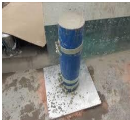
Figura 8: Ensaio na coluna de segregação
