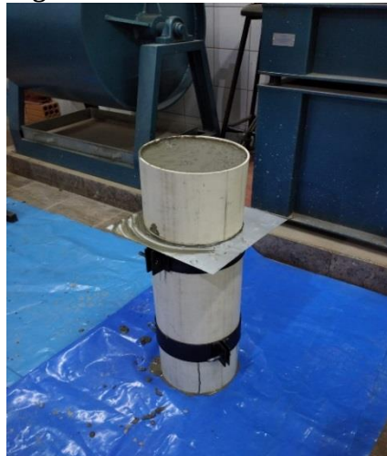
Figura 23: Coluna sendo seccionada
