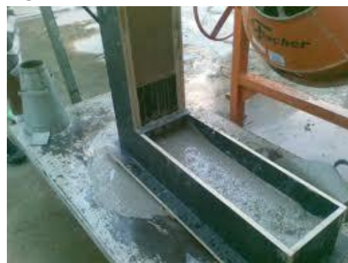
Figura 4: Ensaio na caixa L.
