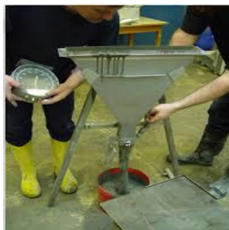
Figura 6: Ensaio no funil V.
