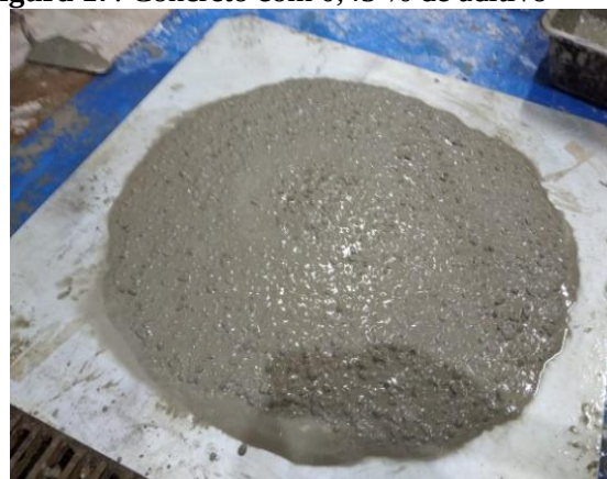
Figura 17: Concreto com 0,45 % de aditivo
