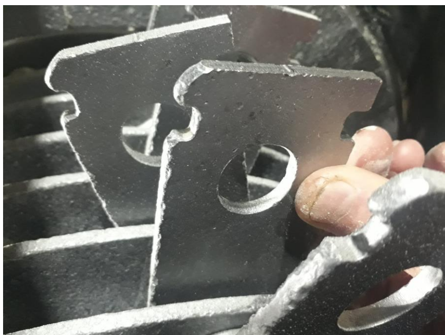
Figura 24: Detalhe da condição do martelo de Hardox 500 em 30/10/2021.
