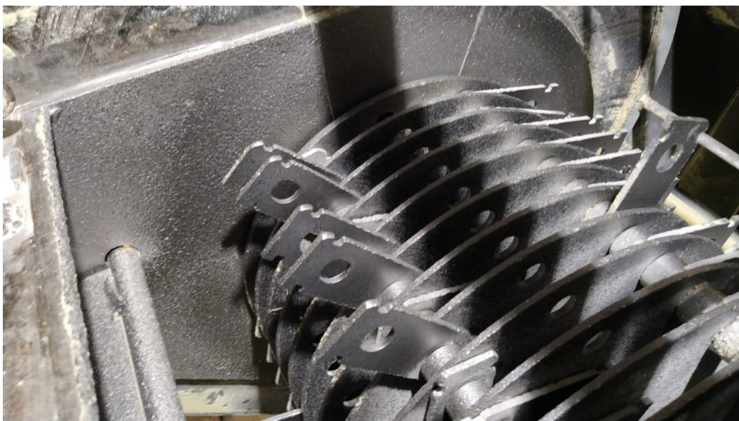
Figura 23: Câmara de moagem com martelos de Hardox 500.
