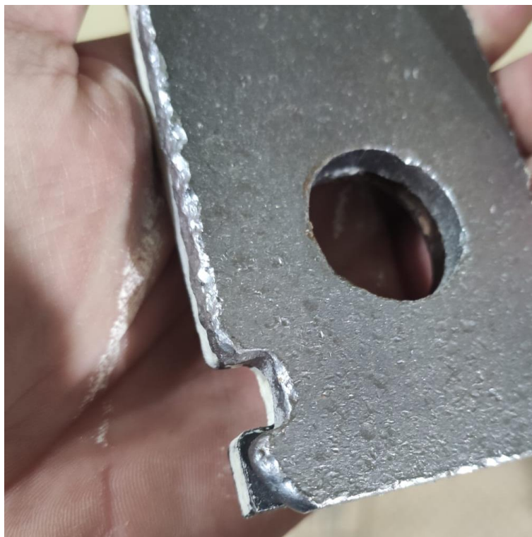
Figura 25: Comparativo de desgaste do martelo de Hardox 500 em 30/10/2021 com um martelo novo.
