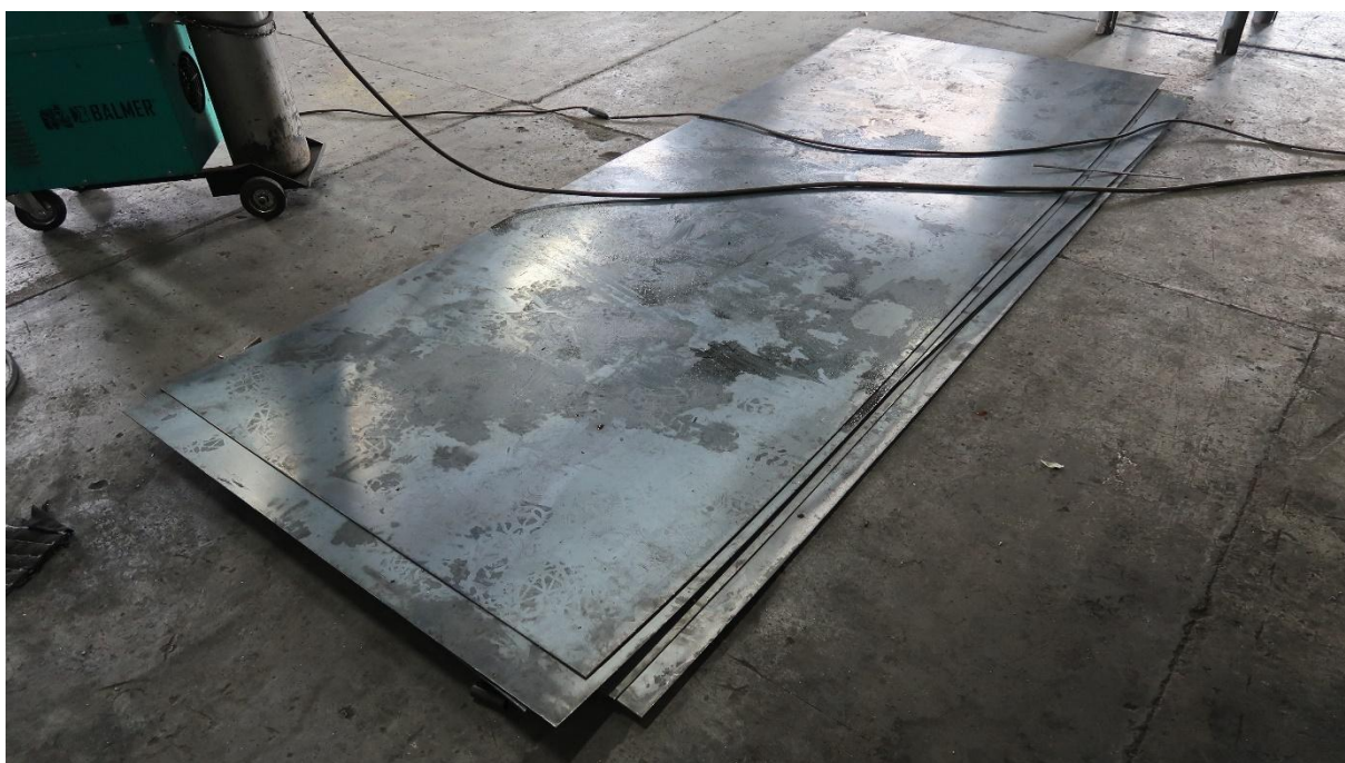
FIGURA 8: Chapas metálicas de 1,20 x 3,00 m (chapa 12) compradas.
