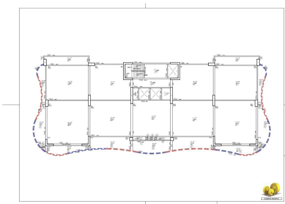
FIGURA 1: Vista superior do edifício com a viga curvada.
