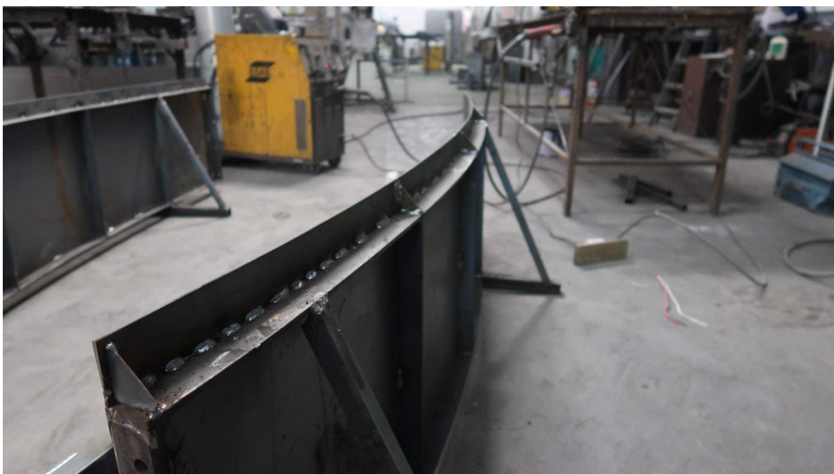
FIGURA 18: Soldagem do aumento da altura da chapa externa.
