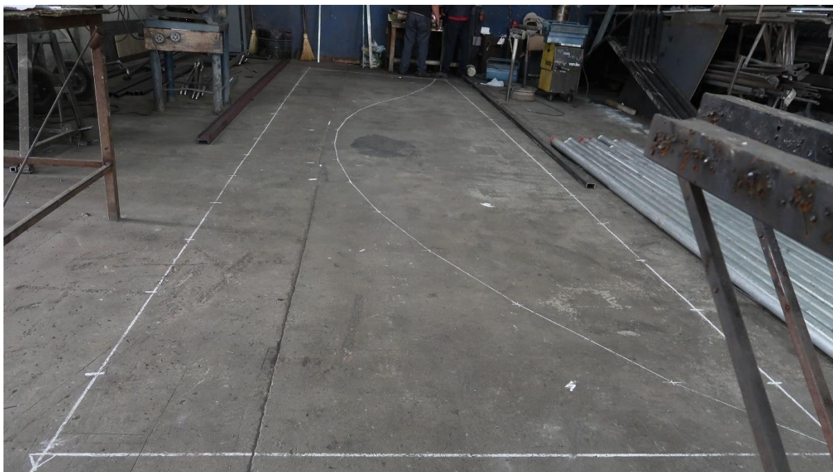
FIGURA 12: Gráfico desenhado no chão da metalúrgica para calandrar a chapa metálica.
