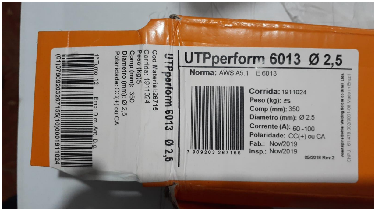
FIGURA 23: Eletrodo revestido utilizado na obra
