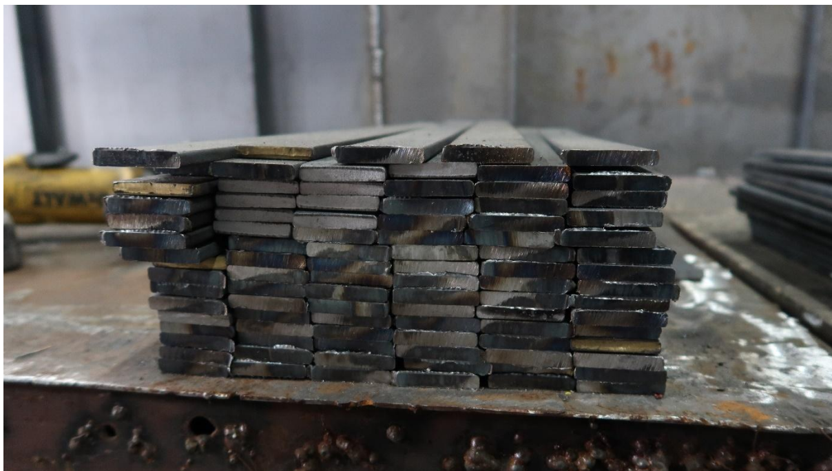
FIGURA 9: Pedações de barra chata cortados com 50 centímetros.
