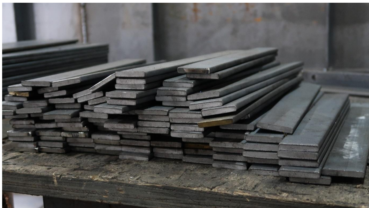
FIGURA 10: Pedações de barra chata cortados com 30 centímetros.
