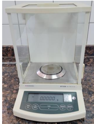
Figura 12 – Balança analítica, Marca: SHIMADZU Modelo: AY220
