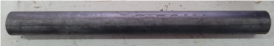
Figura 1 - Tarugo de Aço SAE 1020 Fonte: Próprio autor (2021).
