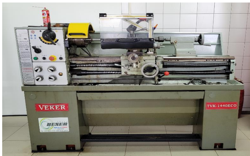
Figura 6 - Torno mecânico Marca: VEKER Modelo: TVK– 1440ECO Fonte: Próprio autor (2021).
