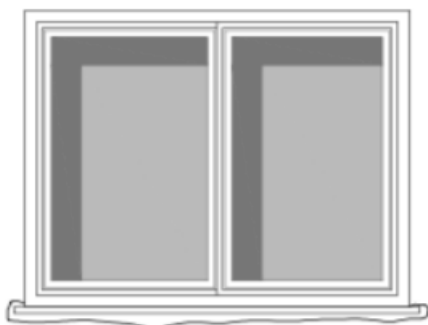
Figura 8 - Fissura sob o peitoril
