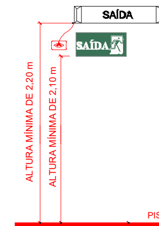
DETALHE DE PLACA DE SINALIZAÇÃO INDICATIVA DE SAÍDA DE EMERGÊNCIA ACIMA DA PORTA SEM ESCALA
