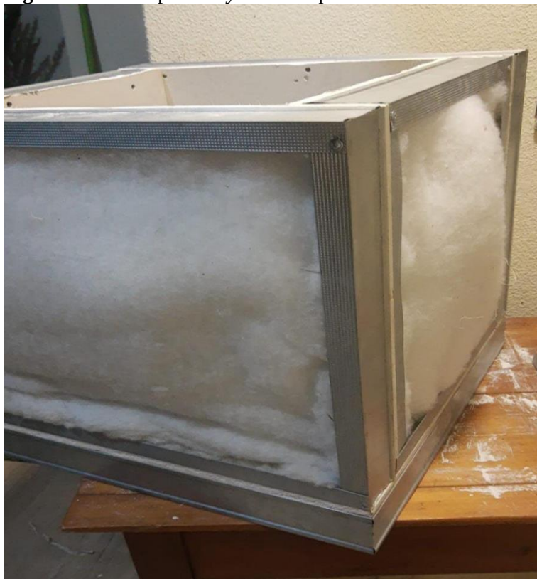
Figura 8 – Protótipo de drywall com preenchimento de lã de PET.
