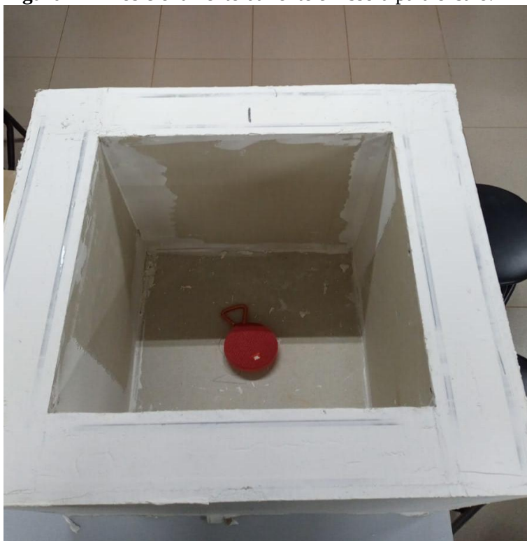
Figura 11 – Posicionamento da fonte emissora para ensaio.
