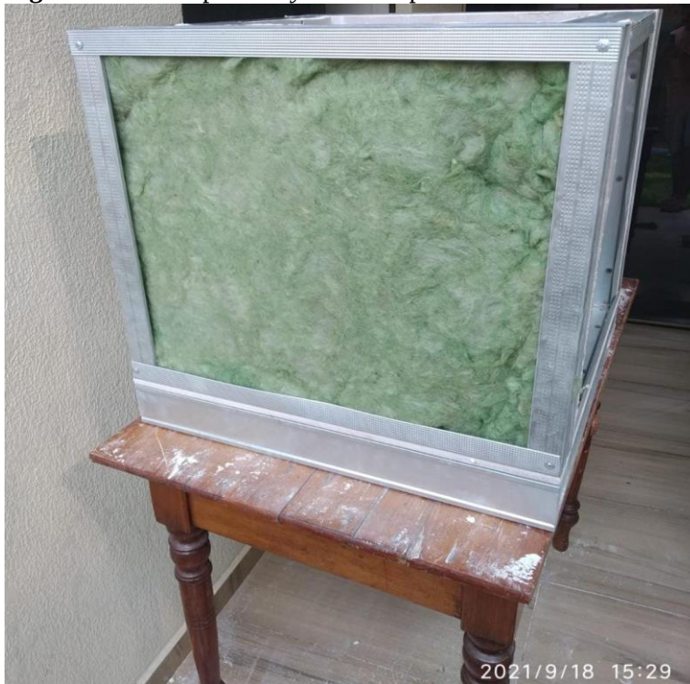
Figura 7 – Protótipo de drywall com preenchimento de lã de rocha.
