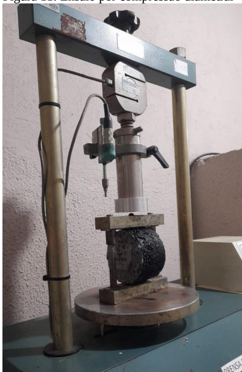
Figura 11: Ensaio por compressão diametral
