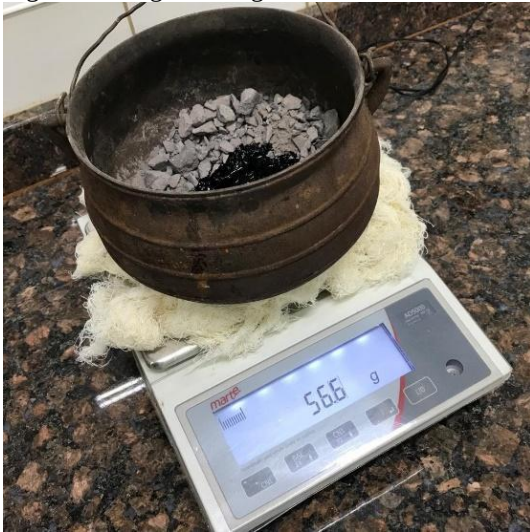
Figura 8: Pesagem do ligante asfáltico
