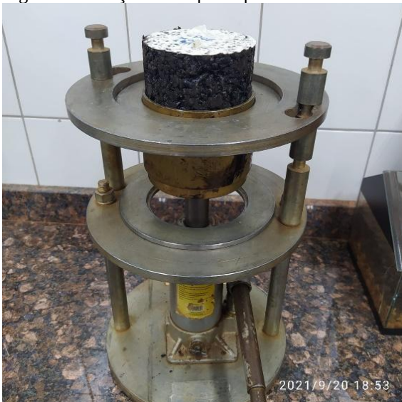
Figura 9: Extração do corpo de prova
