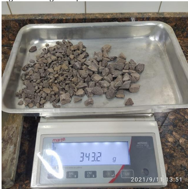
Figura 7: Pesagem do pedrisco 5/8"
