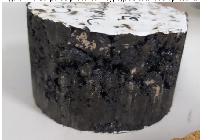
Figura 12: Corpo de prova com agregado saturado apresentando falta de adesividade
