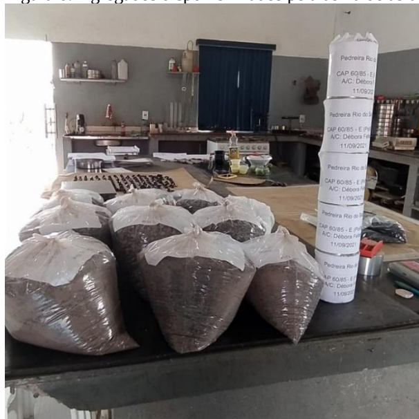
Figura 6: Agregados disponibilizados pela usina de asfalto
