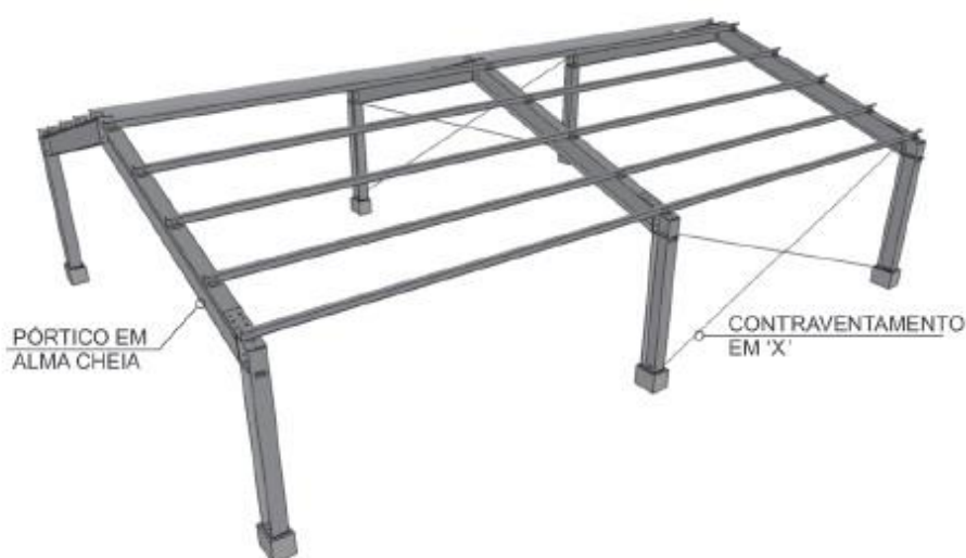
Figura 8: Contraventamento em “X” em estrutura metálica.
