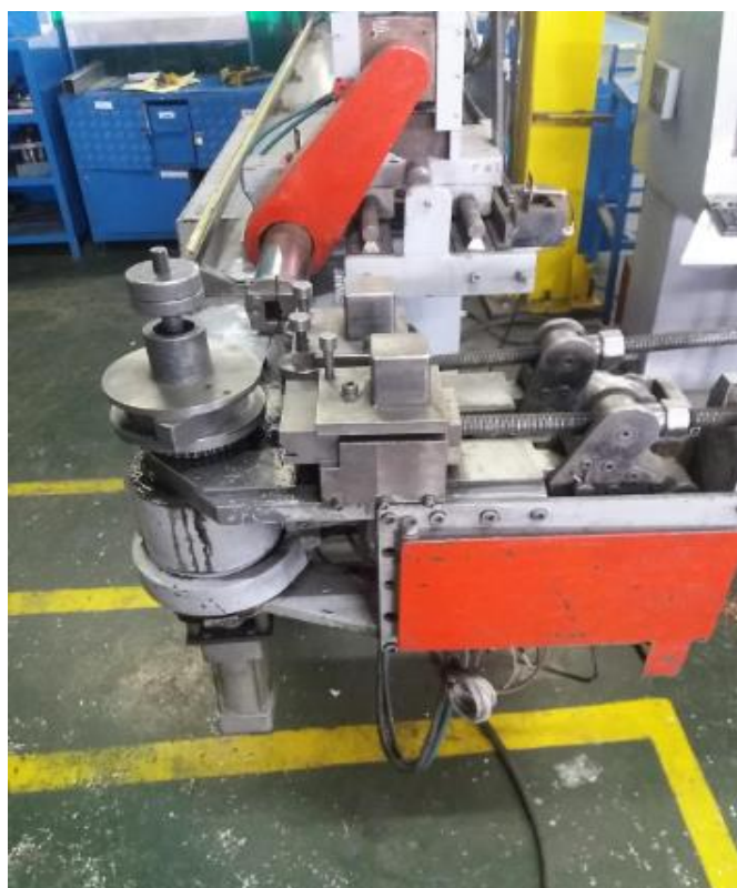
Figura 7: Dobradeira CNC de perfis e tubos.
