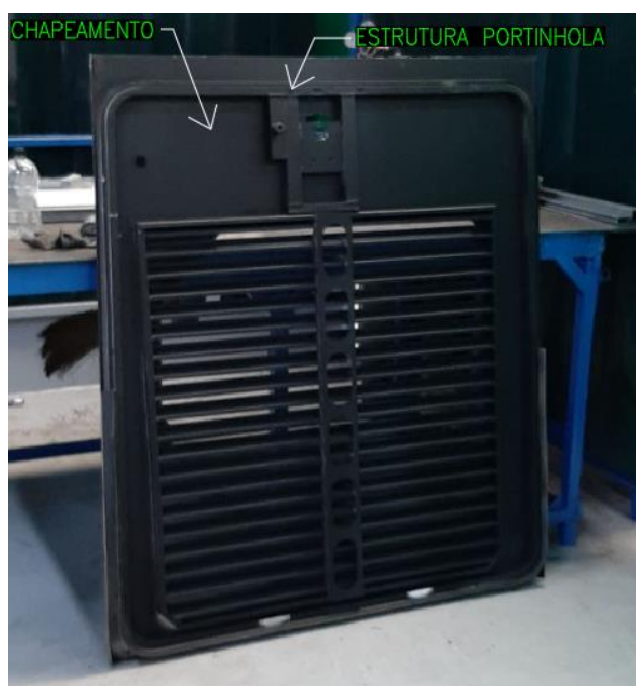
Figura 5: Portinhola do compartimento do radiador
