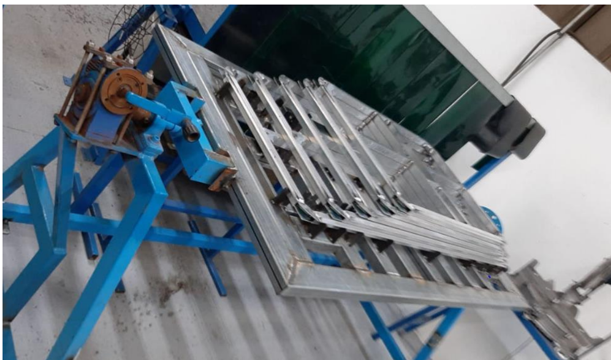
Figura 14: Gabarito e estruturas de portinholas
