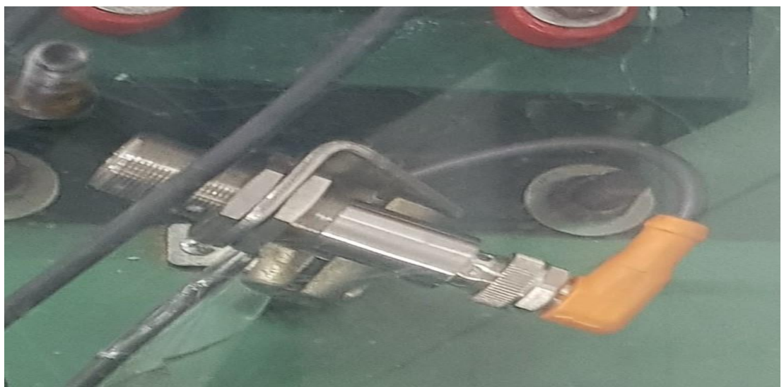
Figura 2: Sensores piezoelétricos modelo VSA001 de marca IFM.
