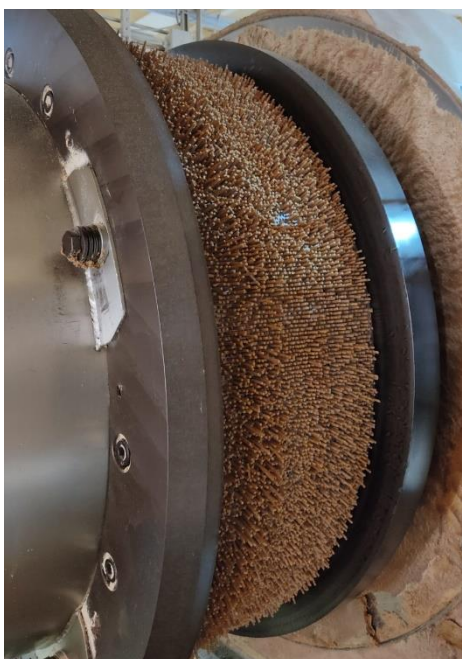
Figura 5: Formação do pellet (Fonte: Autor, 2021)
