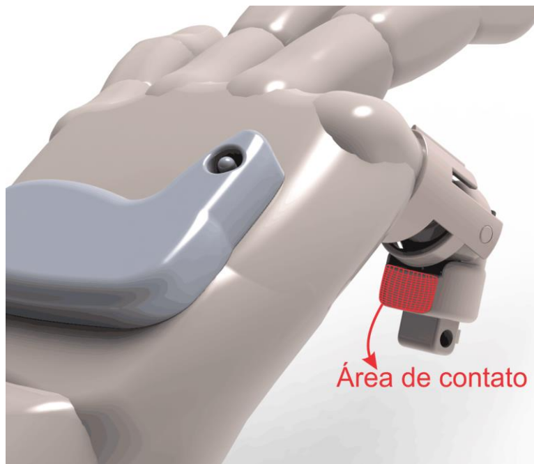
Figura 35 – área de contato da prótese com os objetos
