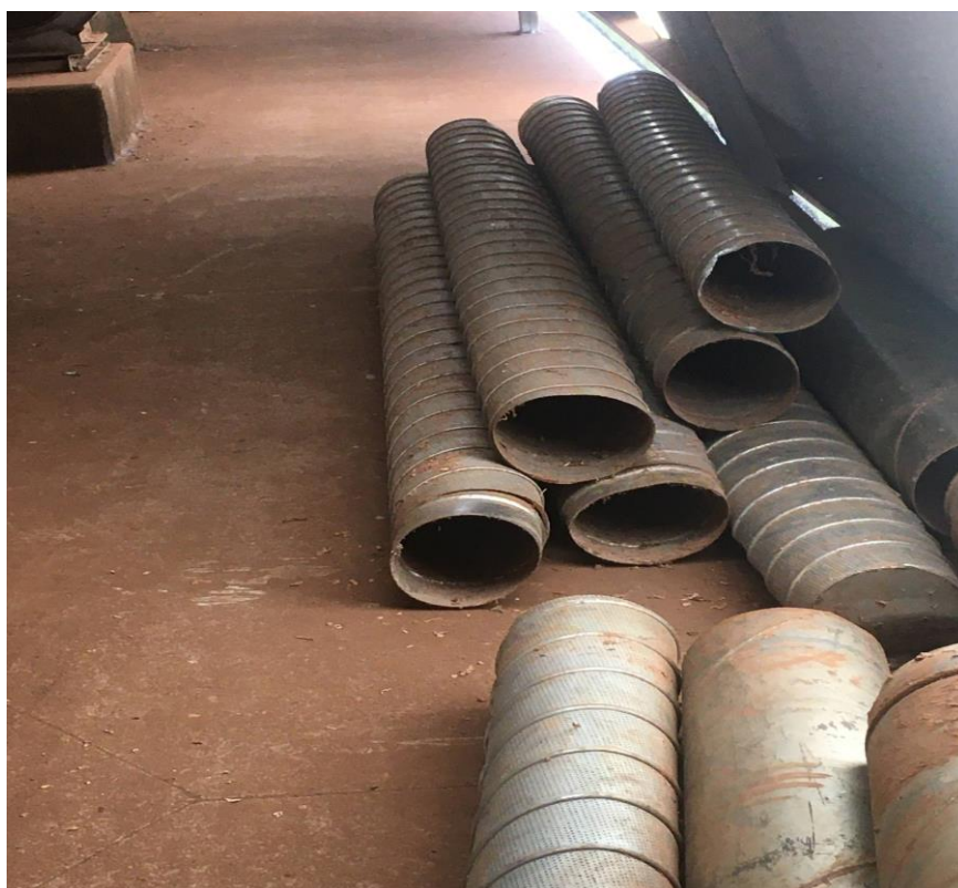
Figura 8 – Dutos de aeração amassados
