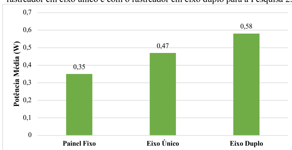
Gráfico 3 - Potência média apresentada para o sistema com o painel fotovoltaico fixo, com o rastreador em eixo único e com o rastreador em eixo duplo para a Pesquisa 2.
