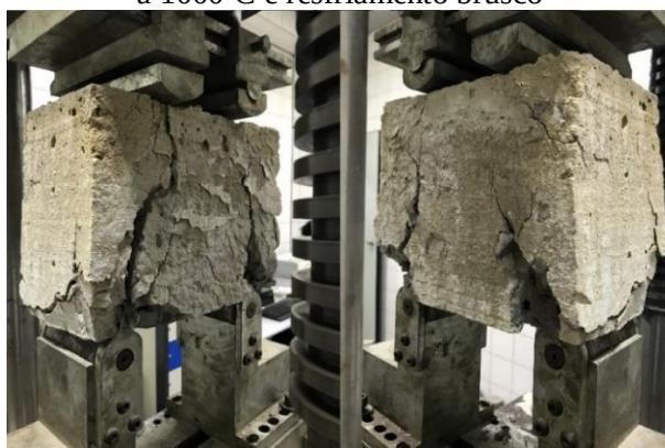
Figura 10 – Ruptura do corpo de prova com aço estrutural após ensaio de tração na flexão após ser submetida a 1000°C e resfriamento brusco
