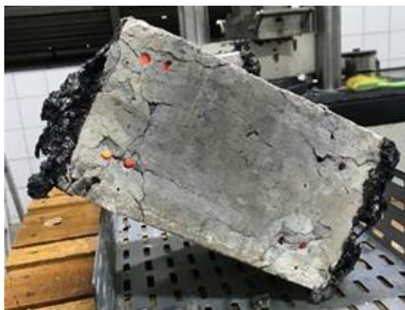
Figura 12 – Corpo de prova moldado com barras de GFRP após resfriamento brusco.
