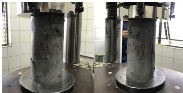
Figura 5 – Ruptura de corpos de prova submetidos à compressão axial.
