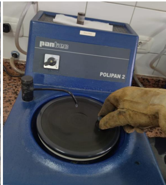
Figura 05 – Processo de lixamento
