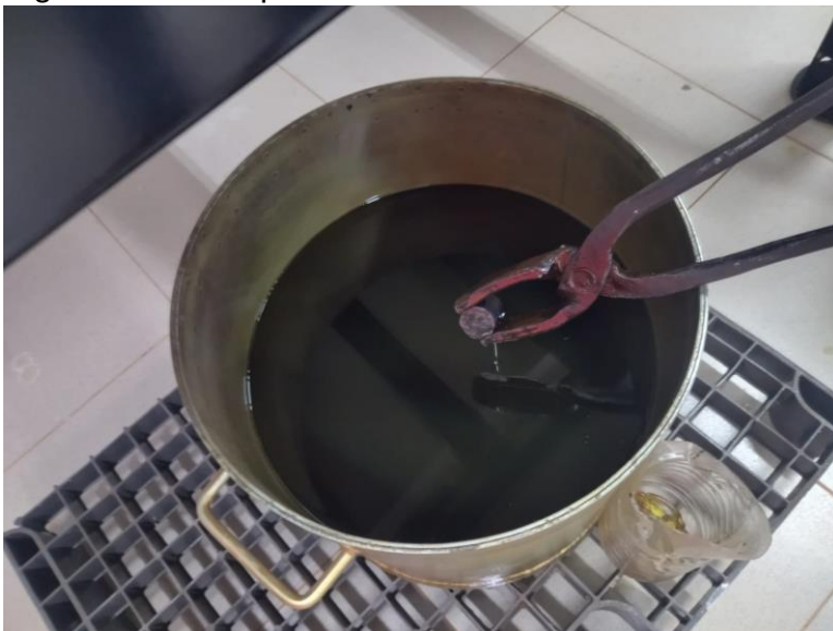
Figura 06 – Têmpera das amostras
