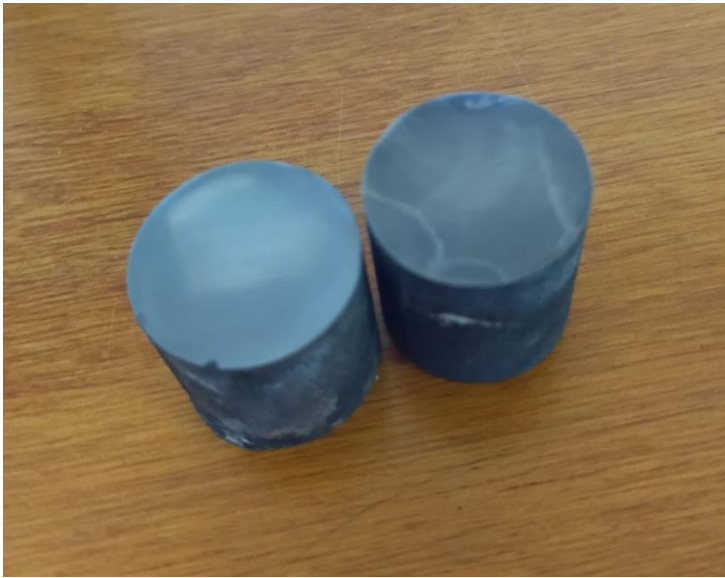
Figura 12 – Face de amostras após ataque químico
