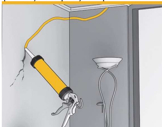
Figura 5 - Representação da aplicação da pasta elástica acrílica na fissura
