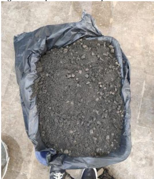
Figura 5 - Traço 1 com substituição de 50% de areia por pneu em pó
