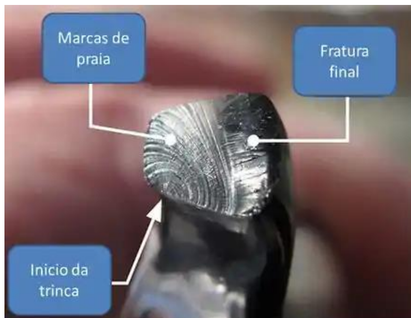
Figura 2 – Marcas de praia de um material rompido por fadiga. Fonte: Adaptado de Bannantine (1989)
