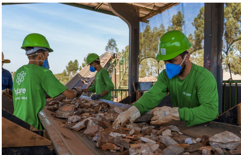
Figura 4 : Processo de separação dos resíduos.
