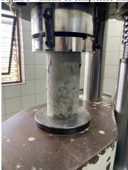
Figura 6 – Ensaio de compressão axial
