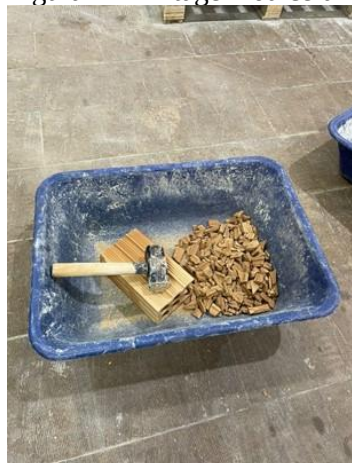
Figura 1 – Britagem da cerâmica
