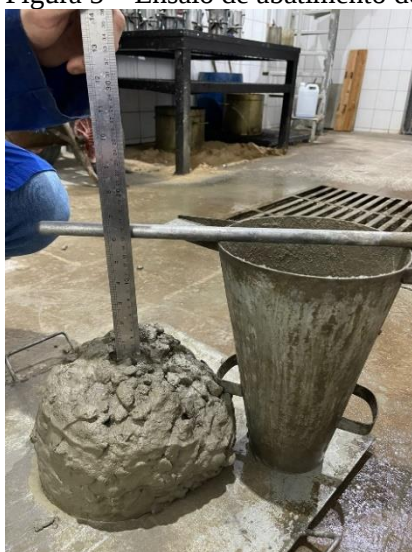
Figura 5 – Ensaio de abatimento do tronco de cone
