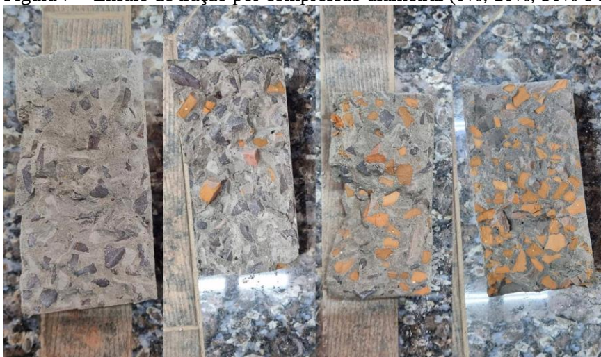
Figura 7 – Ensaio de tração por compressão diametral (0%, 10%, 50% e 100% de substituição)
