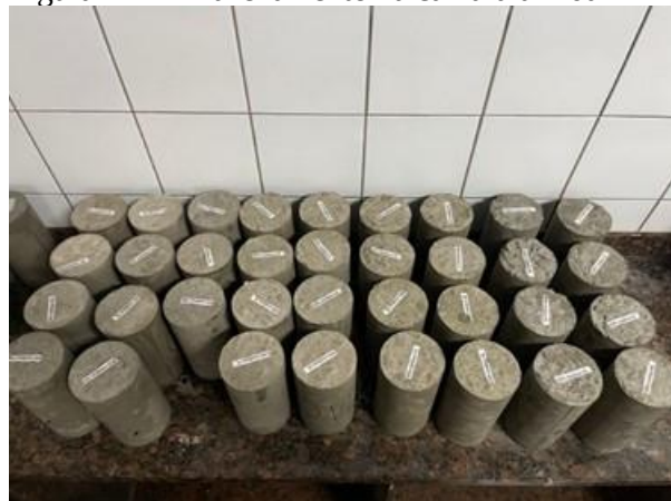
Figura 4 – Armazenamento na câmara úmida
