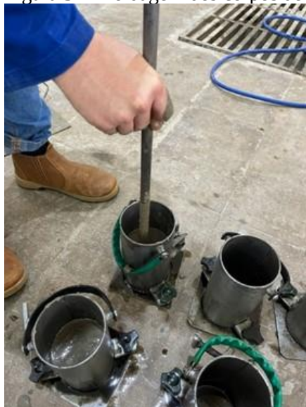
Figura 3 – Moldagem dos corpos de prova
