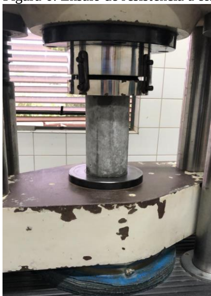
Figura 6: Ensaio de resistência à compressão axial.
