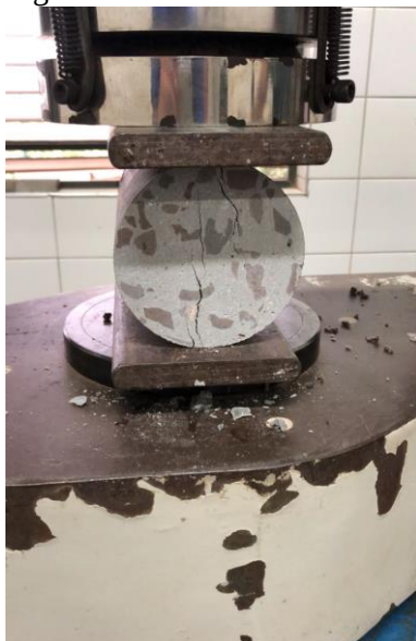
Figura 7: Ensaio de resistência tração por compressão diametral
