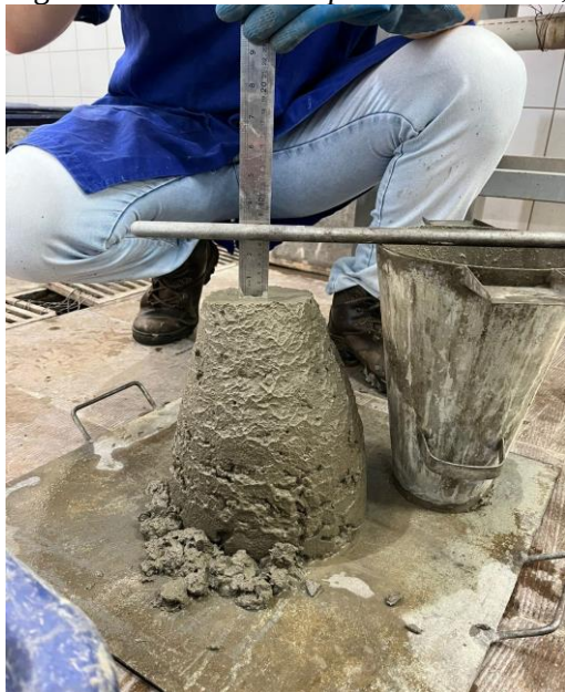
Figura 5: Ensaio de slump test no teor de 0,5%.
