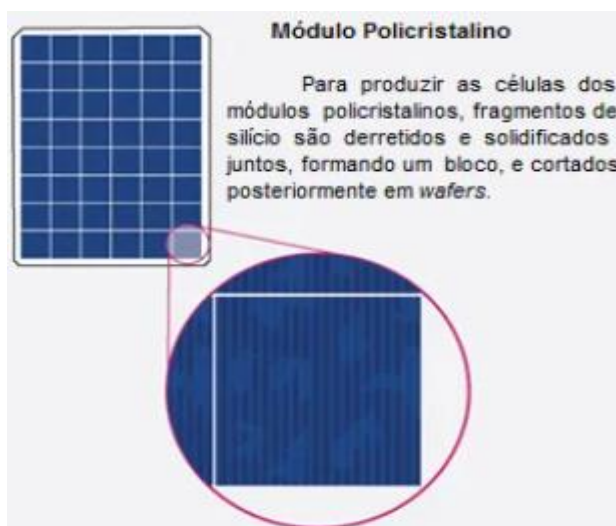
Figura 2.3 – Células de silício Policristalino
