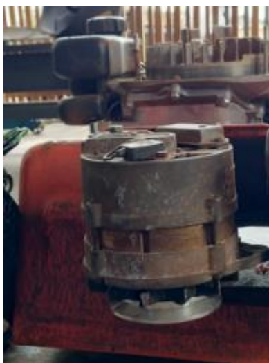
Figura 3.12 - Fixação da polia motriz e alternador no chassi
