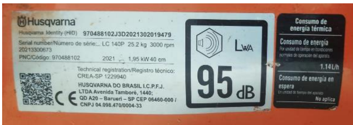
Figura 3.10 – Dados técnicos do motor a combustão
