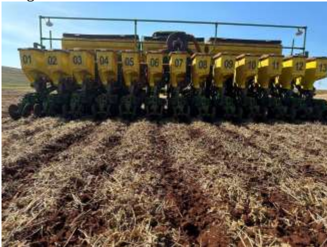
Imagem 7 – Plantadeira com sistema a vácuo
